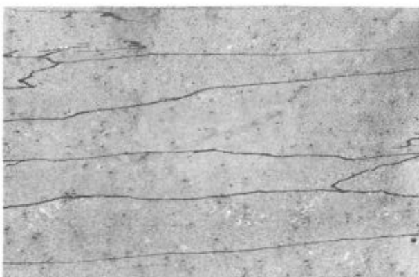
Slika 10 pov. 100 ×. Podolgovata zrna τ faze v zlitini z 70,5 % Mn in 0,5 % C.
