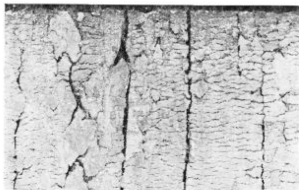
Slika 17 Površina neprekrystaliziranega industrijskega ingota po valjanju v gredico 135 × 135 mm, pov. 1,7 × Fig. 17 Surface of untreated industrial ingot after rolling into 135 × 135 mm billets. Magnification 1.7 ×.
