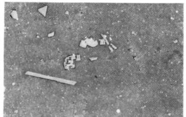
Slika 17 Mikroposnetek žlindre po redukciji Fig. 17 Micropicture of slag after reduction
