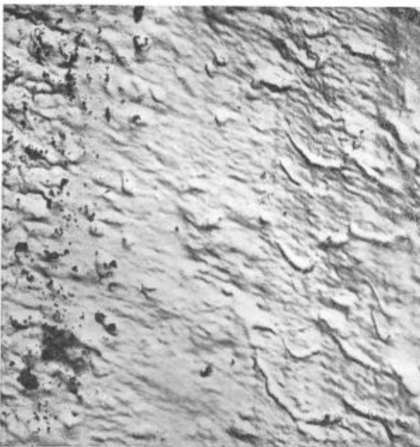
Slika 8 in 9 × 6000. Dvostopenjska replika: plastična snov — ogljje. Mikrofraktofske značilnosti prelomne površine.
