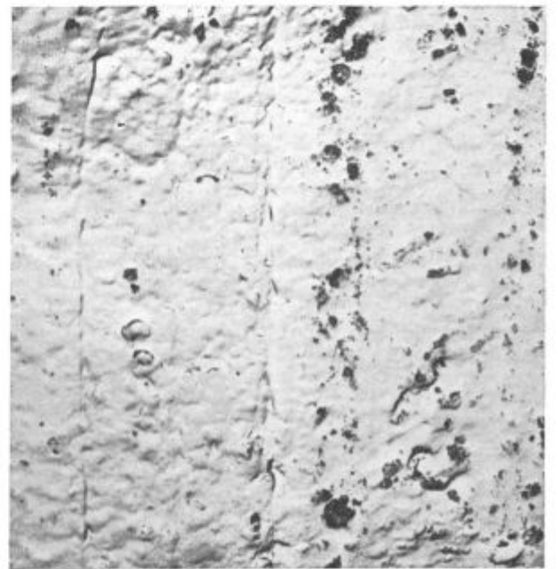
Slika 8 in 9 × 6000. Dvostopenjska replika: plastična snov — ogljje. Mikrofraktofske značilnosti prelomne površine.
