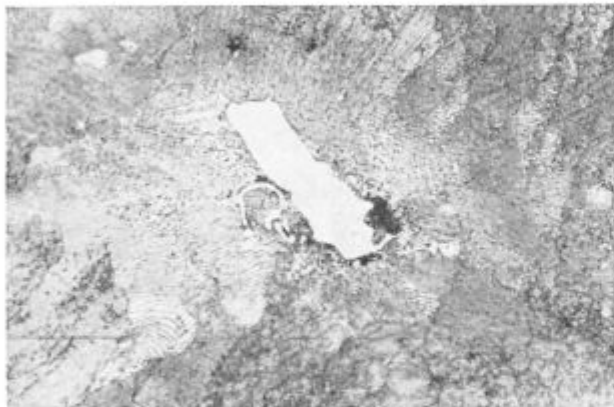
Slika 2 × 500, poligonalno karbidno zrno
