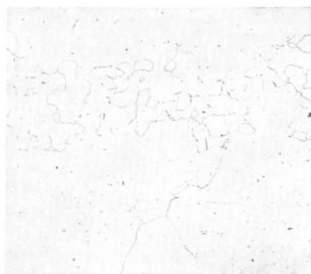
Slika 13 — 100 × Naraščanje zrn v razogljčeni coni pri 800° C
