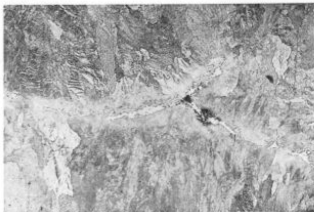
Slika 4 × 200, karbidno zrno na stiku treh grobih kristalnih zrn
