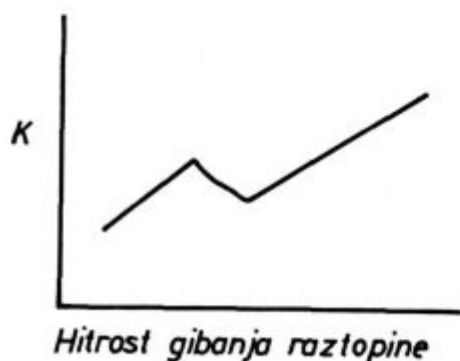
Slika 4 Vpliv gibanja korozijskega sredstva na hitrost korozije
