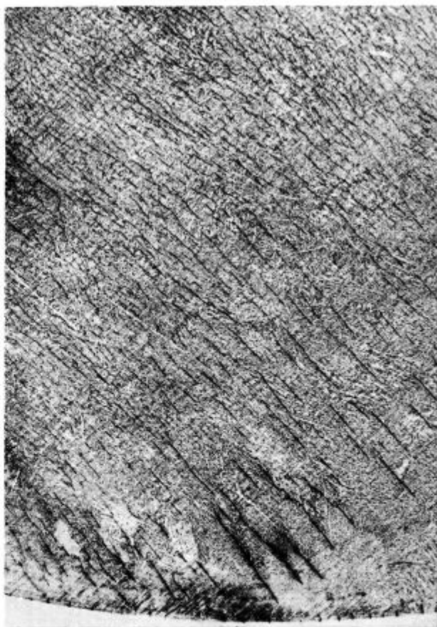
Slika 28 Brusilne razpoke na osnovni ploskvi noža, pov. pribl. 2 ×
