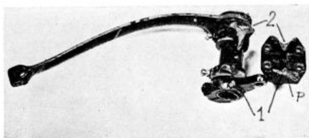
Slika 1 Ročica in prelomljeni nosilec, pomanjšano pribl. 4×
