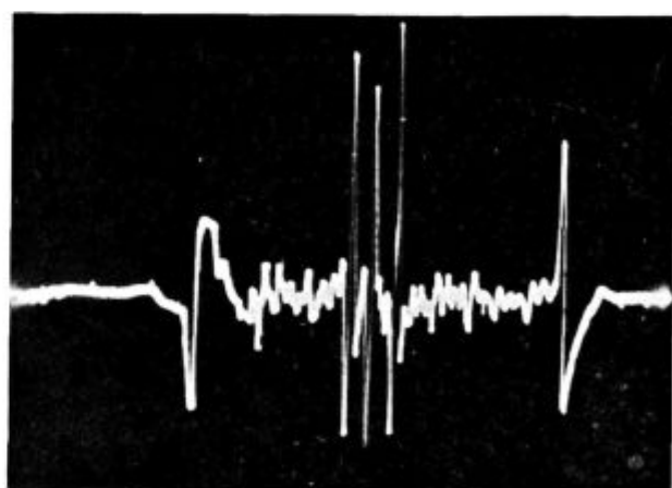
Slika 6 f Magnetografski posnetek pri visokih občutljivostih na palici \varnothing 25 mm s tremi razpokami Globina razpok 0,4 do 0,6 mm
