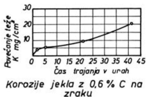
Slika 19 Vpliv časa pri 800° C na oksidacijo površine
