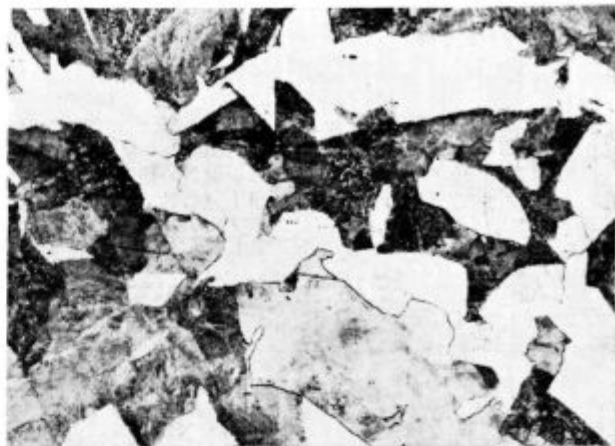
Slika 9 d Talina 10, 1200° C, trakavost 1
