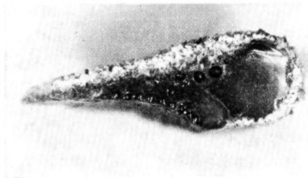
Slika 6 Strjena žindra na robovih navara
