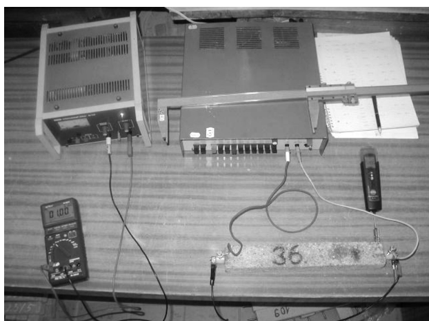
Figure 3: MER of embedded steel bars using a set of apparatus Slika 3: MER-vgrajene jeklene palice, z uporabo sklopa naprav
