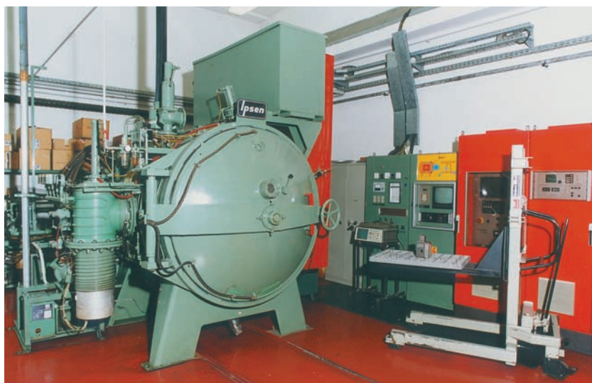
Slika 1: Enokomorna vakuumška peč Ipsen VTTC324-R s homogenim plinskim ohlajanjem pod visokim tlakom
