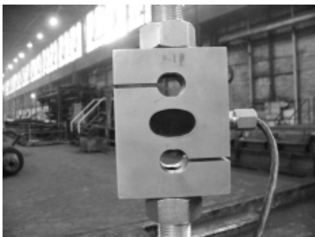
Slika 1: Električna celica za merjenje sile Figure 1: Electrical cell for measurement of force
