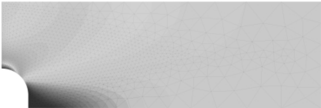
Figure 6: Representation of the horizontal stress distribution in a plate with a semi-circular notch Slika 6: Predstavitev horizontalne porazdelitve napetosti v plošči s polkrožno zarezo
