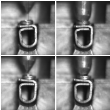
Slika 7: Prikaz ponovljivosti pozicije dveh različnih kontaktov v nosilcu (križ pomeni mesto vara): (levo) prosto vstavljanje, (desno) dodatno prijetanje
