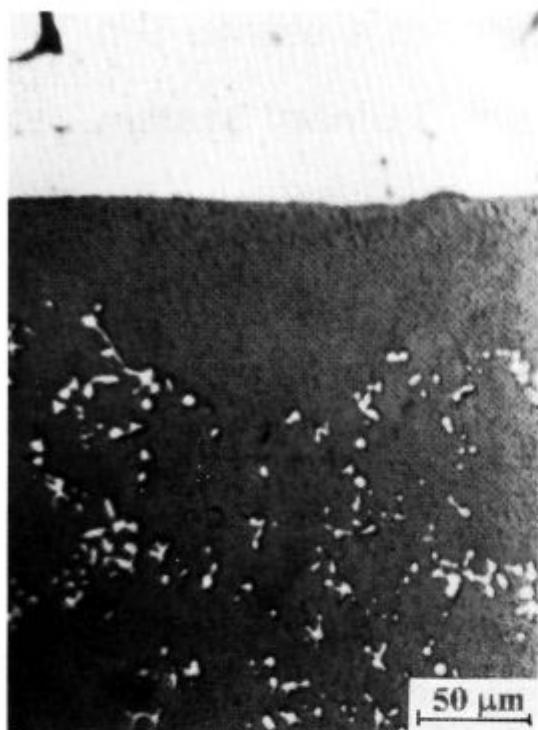
Slika 1: Mikrostruktura Sm-Ti zlitine (svetlo Ti, temno Sm, prikaz razmešanja enofazne taline na spodnjo plast, bogato s samarijem - L_{(Sm)} in zgornjo, bogato s titanom - L_{(Ti)} )
