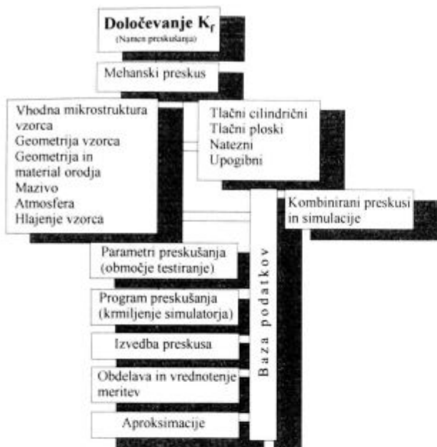
Slika 2: Osnovna shema preskušanja Figure 2: Basic testing scheme
