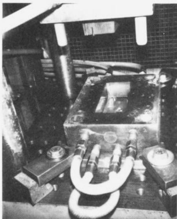
Slika 1. Orodje za traktorsko lečo neparjeno s TiN.
