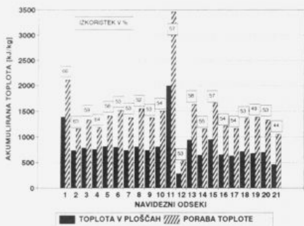
Slika 4. Izkoristek kemijske toplote goriva v intervalih med pomiki testne plošče skozi peč.
